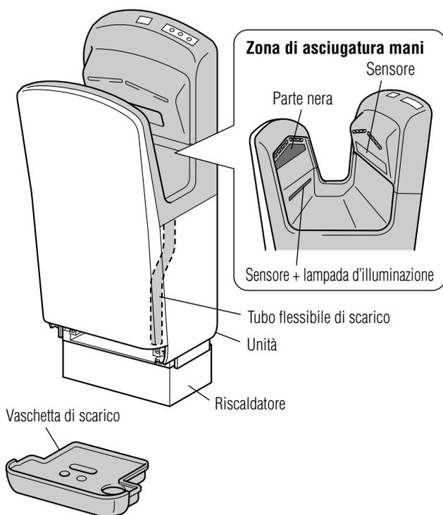
■ Il rivestimento antimicrobico rivela la sua efficacia allorché i batteri vengono a contatto delle superfici (parte tratteggiata in figura a sinistra).
