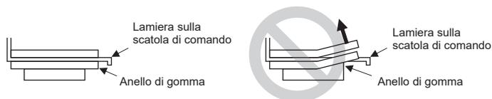
\*3 Nel fissare il nastro fornito intorno all'anello di gomma, fare in modo da non lasciare spazi tra le estremità.
