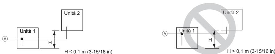
(4) La separazione verticale tra le unità (H) deve essere di 0,1 m (3-15/16 in) o inferiore. Nella figura a destra, l'olio si accumula nell'unità 2 quando l'unità 1 è in funzione e l'unità 2 è ferma perché la distanza è maggiore di 0,1 m (3-15/16 in).
