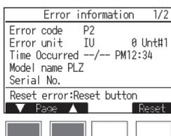
Appaiono codice errore, errore unità, indirizzo refrigerante, nome modello unità, numero di serie. Il nome modello e il numero di serie appaiono solo se le informazioni sono state registrate.
