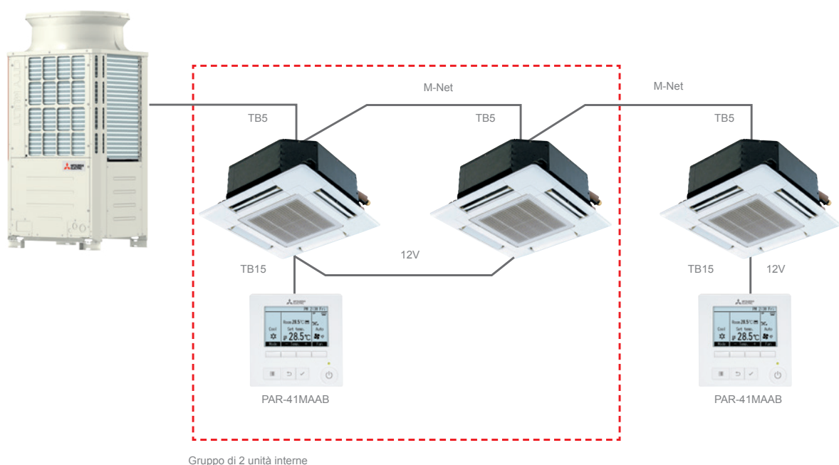
ESEMPIO COLLEGAMENTO COMANDO A FILO (TIPOLOGIA MA)
