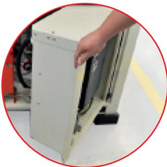
Pannelli del quadro elettrico estraibili per facilitare l'accesso a tutti i componenti interni
