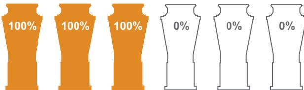
Utilizzando unità equipaggiate con compressori a velocità fissa, è possibile soltanto accendere o spegnere l'unità e la frequenza del compressore non può essere regolata in base alla capacità richiesta dall'impianto.
