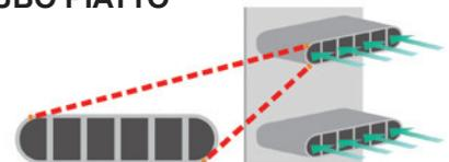
Le alette all'interno del tubo piatto dividono il flusso di refrigerante in diversi percorsi e migliorano l'efficienza dello scambiatore di calore. I tubi piatti riducono la resistenza al vento e aumentano il numero di tubi per unità di superficie, con un miglioramento generale dell'efficienza nello scambio termico.
