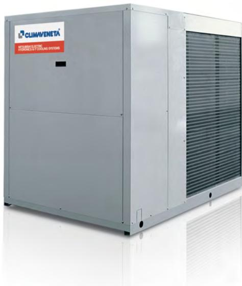
Unità da esterno "split system" per il collegamento con batterie di espansione diretta o scambiatori remotizzati, con compressori ermetici rotativi di tipo scroll, ventilatori elicoidali, rubinetti di aspirazione e mandata compressore con prese di servizio e rubinetto del liquido Pannellatura esterna in peraluman e basamento in lamiera d'acciaio zincata e verniciata. Refrigerante R407C, unità a due e quattro compressori, due circuiti refrigerante.
