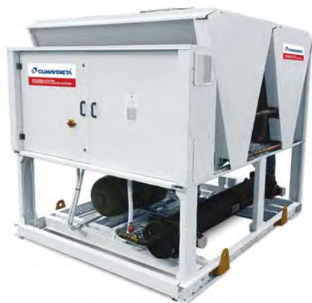
Unità da esterno per la produzione di acqua refrigerata con compressore a vite di tipo semiermetico dedicati per l'utilizzo di R513A, ventilatori elicoidali, batterie di condensazione a microcanale realizzata totalmente in alluminio, evaporatore a fascio tubiero monopasso di progettazione Mitsubishi Electric Hydronics & IT Cooling Systems S.p.A. (evaporatore a piastre saldobrasate per le taglie 0751 e 0851) e valvola di espansione elettronica.
