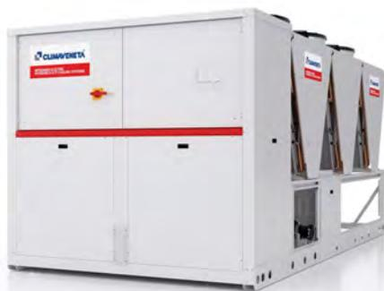
Unità da esterno per la produzione di acqua refrigerata con compressori ermetici rotativi di tipo Scroll dedicati per l'utilizzo di R454B, ventilatori elicoidali, batterie di condensazione a microcanale realizzata totalmente in alluminio, evaporatore a fascio tubiero di progettazione e realizzazione interna e valvola di espansione elettronica. La gamma comprende modelli con 4 compressori su 2 circuiti indipendenti.
