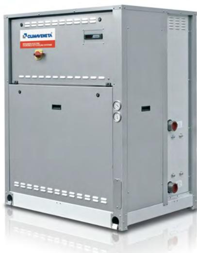
Unità da interno per la produzione di acqua refrigerata abbinabile ad un condensatore remoto con compressori ermetici rotativi di tipo scroll a R410A, scambiatore a piastre saldo-brasate e valvola di espansione termostatica. Basamento e pannellatura in lamiera d'acciaio zincato a caldo e verniciato.
