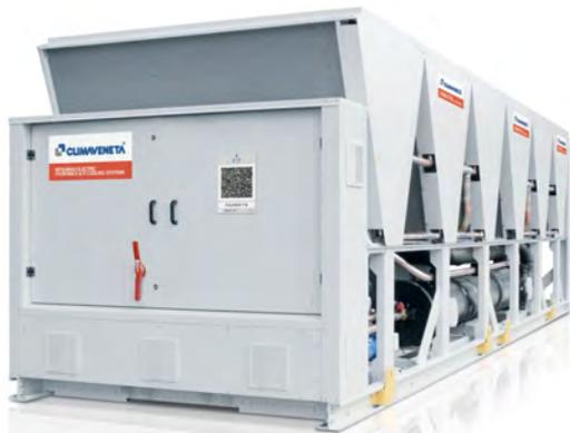
Unità da esterno per la produzione di acqua refrigerata con compressori a vite di tipo semiermetico dedicati per l'utilizzo di R513A, ventilatori elicoidali, batterie di condensazione a microcanale realizzata totalmente in alluminio, evaporatore a fascio tubiero monopasso di progettazione Mitsubishi Electric Hydronics & IT Cooling Systems S.p.A. e valvola di espansione elettronica.
