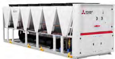
Unità da esterno per la produzione di acqua refrigerata con compressori monovite a velocità variabile di tipo semiermetico dedicati per l'utilizzo di R513A, ventilatori EC, batterie di condensazione a microcanale realizzata totalmente in alluminio, evaporatore a fascio tubiero monopasso, valvola di espansione elettronica ed economizzatore.
