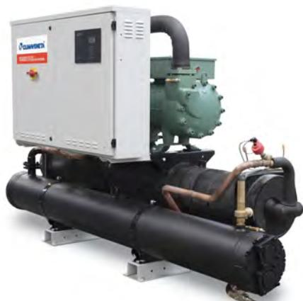
Unità da interno per la produzione di acqua refrigerata con compressori a vite di tipo semiermetico ottimizzati per lavorare con bassi rapporti di compressione e per l'utilizzo di R513A, evaporatore a fascio tubiero di progettazione Mitsubishi Electric Hydronics & IT Cooling Systems S.p.A., condensatore a fascio tubiero e valvola di espansione elettronica.
