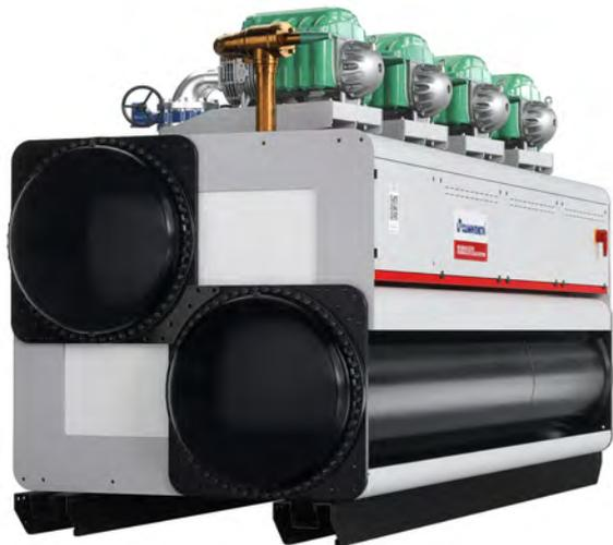
Unità da interno per la produzione di acqua refrigerata con compressori centrifughi oil-free, utilizzo di R1234ze, condensatore a fascio tubiero, evaporatore allagato a fascio tubiero e valvola di regolazione elettronica.
