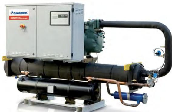
Unità da interno per la produzione di acqua refrigerata abbinabile ad un condensatore remoto, con compressori a vite di tipo semiermetico dedicati per l'utilizzo di R134a, evaporatore a fascio tubiero a struttura asimmetrica di progettazione Mitsubishi Electric Hydronics & IT Cooling Systems S.p.A. e valvola di espansione termostatica.
