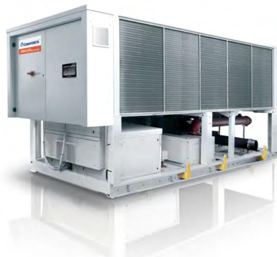
Unità da esterno per la produzione di acqua refrigerata, equipaggiate con compressori centrifughi oil-free, refrigerante R513A, ventilatori elicoidali EC, batteria di condensazione con tubi in rame e alette in alluminio, evaporatore allagato a fascio tubiero e valvola di espansione elettronica. Basamento, struttura e pannellatura in lamiera di acciaio zincata verniciata con polveri poliesteri. Unità fornita completa di carica refrigerante.
