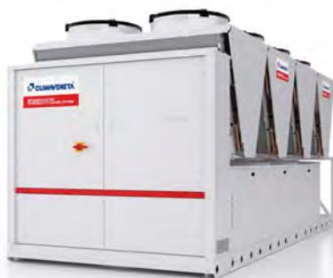
Unità da esterno per la produzione di acqua refrigerata con compressori ermetici rotativi di tipo Scroll dedicati per l'utilizzo di R454B, ventilatori elicoidali, batterie di condensazione a microcanale realizzata totalmente in alluminio, evaporatore a fascio tubiero di progettazione e realizzazione interna e valvola di espansione elettronica. La gamma comprende le versioni a quattro, cinque, sei e otto compressori, tutte multicircuito.
