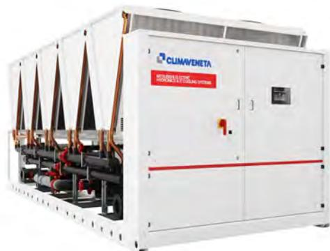
Unità da esterno per la produzione di acqua refrigerata ad alta temperatura, equipaggiate con compressori ermetici scroll, refrigerante R454B, ventilatori elicoidali, batterie di condensazione a microcanale in alluminio, evaporatore a fascio tubiero e valvole di espansione elettroniche. Basamento, struttura e pannellatura in lamiera di acciaio zincata verniciata con polveri poliesteri.
