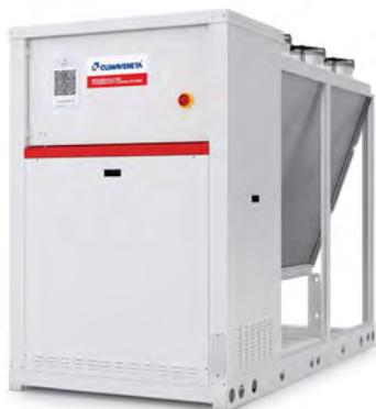
Unità da esterno per la produzione di acqua refrigerata con compressori ermetici rotativi di tipo Scroll dedicati per l'utilizzo di R454B, ventilatori elicoidali, batterie di condensazione a microcanale realizzata totalmente in alluminio, evaporatore a piastre saldobrasate e valvola di espansione elettronica. La gamma comprende le versioni a due compressori con monocircuito.
