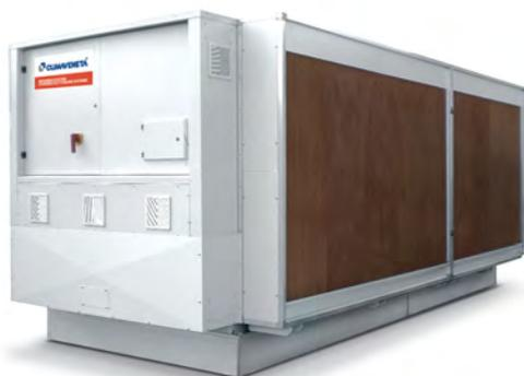
Unità da esterno per la produzione di acqua refrigerata, equipaggiate con compressori centrifughi oil-free, refrigerante R134a, ventilatori elicoidali EC, batteria di condensazione con tubi in rame e alette in alluminio, evaporatore allagato a fascio tubiero, sistema di raffreddamento evaporativo e valvola di espansione elettronica. Basamento, struttura e pannellatura in lamiera di acciaio zincata verniciata con polveri poliesteri.
