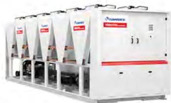
Unità da esterno per la produzione di acqua refrigerata con compressori a vite a velocità variabile di tipo semiermetico dedicati per l'utilizzo di R513A, ventilatori elicoidali, batterie di condensazione a microcanale realizzata totalmente in alluminio, evaporatore a fascio tubiero monopasso di progettazione Mitsubishi Electric Hydronics & IT Cooling Systems S.p.A. e valvola di espansione elettronica.
