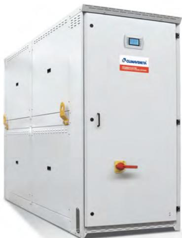
Unità da interno per la produzione di acqua refrigerata con sorgente acqua, compressori ermetici rotativi di tipo Scroll, scambiatori a piastre saldo-brasate e valvola di espansione elettronica di serie. Basamento, struttura e pannellatura in lamiera di acciaio zincato a caldo di adeguato spessore. Verniciatura di tutte le parti con polveri poliesteri che assicura una totale resistenza agli agenti atmosferici, verniciatura RAL 7035.
