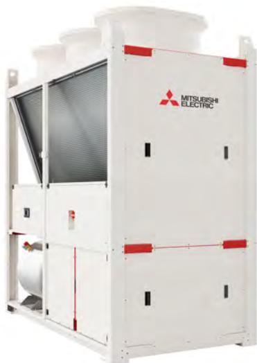
Unità da esterno per la produzione di acqua refrigerata con compressori ermetici di tipo Scroll a velocità variabile in configurazione mono-circuito, con utilizzo di refrigerante R32, batteria di condensazione micro-channel, scambiatore a piastre saldo brasate, ventilatori a velocità variabile (inverter driven) con motore BLDC e valvola di espansione elettronica di serie.
