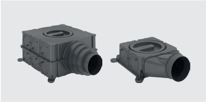
Il box di distribuzione permette di **ripartire l'aria nei diversi ambienti** attraverso tubazioni corrugate di piccolo diametro ( $\varnothing$  75 mm) che vengono direttamente connesse ai box di distribuzione.
