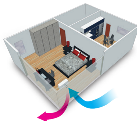
SCHEMA RECUPERO CALORE
