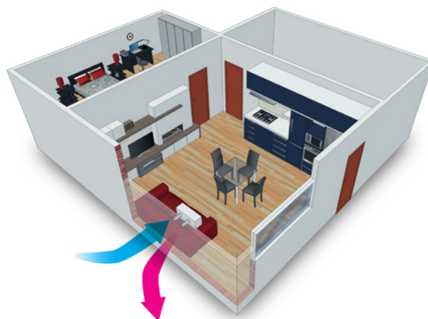
SCHEMA RECUPERO CALORE
