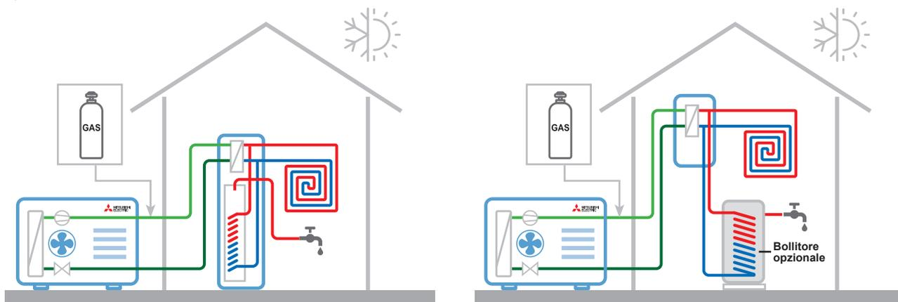
**SOLUZIONE AD INCASSO CON PRODUZIONE DI ACQUA CALDA SANITARIA**
