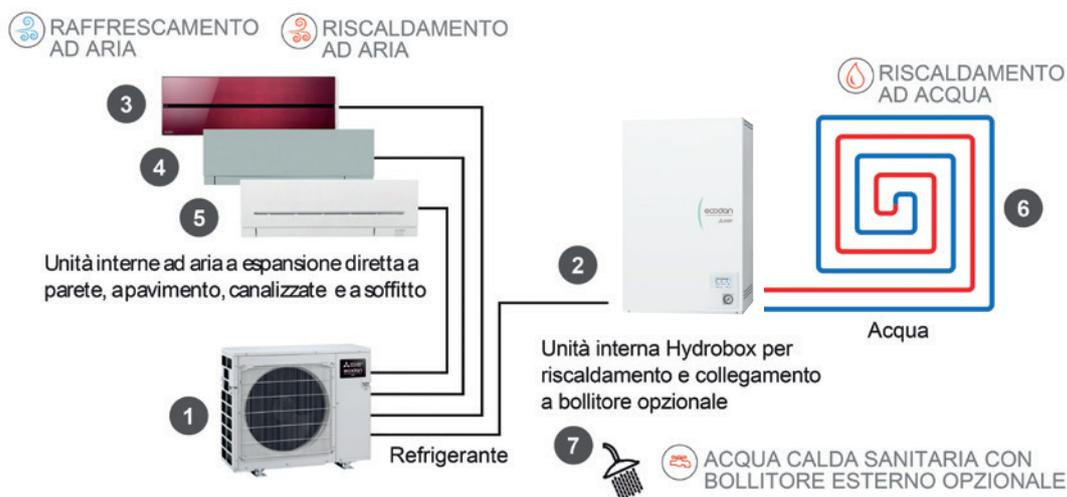
**Hydrobox:** è possibile soddisfare tutte le esigenze di riscaldamento e raffrescamento. Ad esso è possibile associare un bollitore opzionale esterno per l'acqua calda sanitaria.
